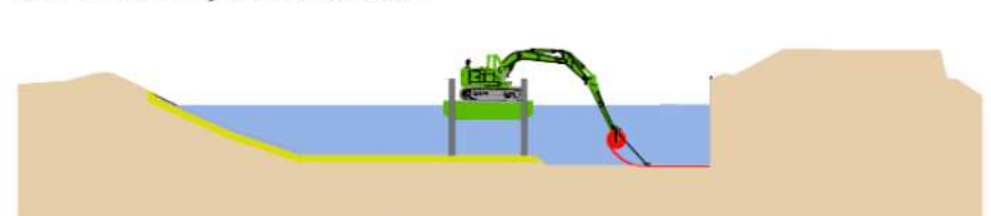
STAP 6: Aanbrengen bentonietmatten
